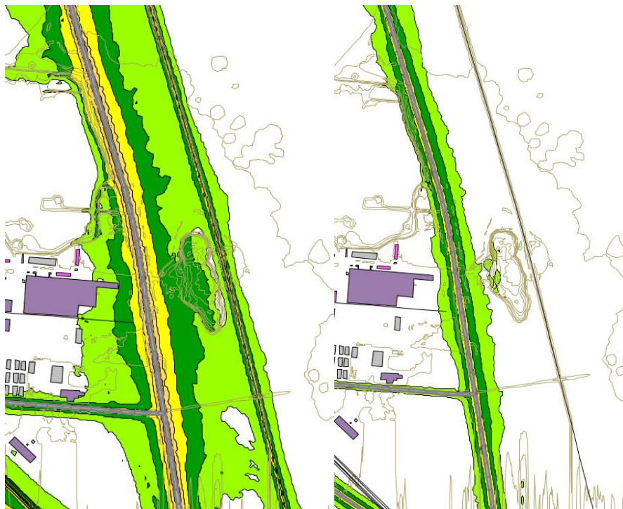
Kuva 31. Kaava-alueen melun nykytilanne 2023. Vasemmalla päiväajan keskiäänitaso ja oikealla yöajan. (WSP Finland Oy, 2024)
