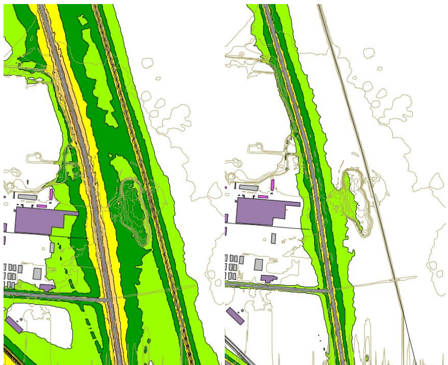
Kuva 32. Kaava-alueen melutilanne, ottaen huomioon liikennemäärien ennusteet. Vasemmalla päiväajan keskiäänitaso ja oikealla yöajan. (WSP Finland Oy, 2024)
